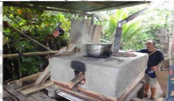
Foto 9. Triangular con bloques refractarios-PN
