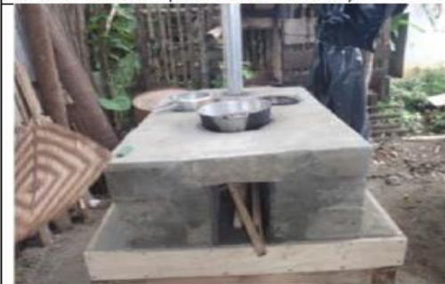
Foto 8. Híbrido lineal de dos fogones (PN)
