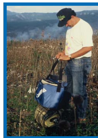
Figura 34 (derecha): Espectrómetro Ge(Li) usado en el monitoreo. Un especialista hondureño lee el espectrómetro Ge(Li) prestado por un experto mexicano en manejo de desechos radiactivos.
