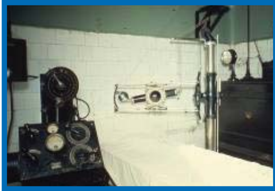
Figura 3: Argentina, 1965—Filtración inadecuada y fuga excesiva en la carcasa del tubo de rayos X.
