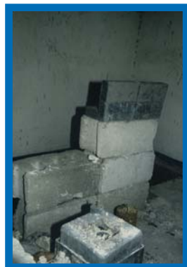
Figura 27: Blindaje improvisado para verificar la existencia de fugas en las fuentes.
