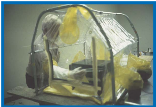
Figura 22: Cámara descartable de manipulación con guantes usada para extraer las fuentes de radio del Instituto del Cibao, Santiago de los Caballeros, República Dominicana, 1991.
