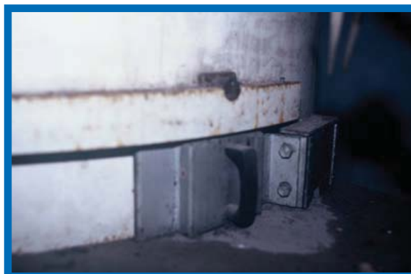
Figura 39: Muestra de cómo cada gaveta podía moverse de lugar para dar acceso a las agujas de radio.
