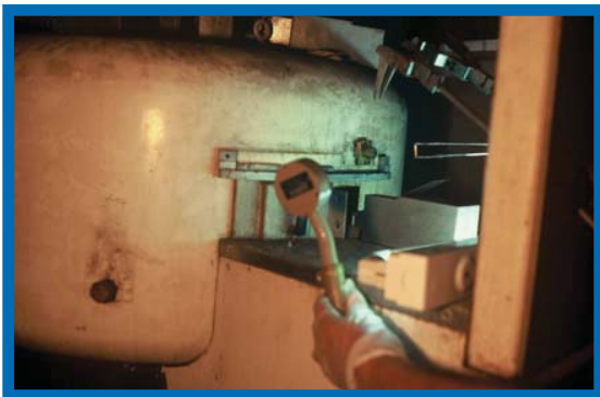
Figura 40: Verificación de la actividad de las fuentes de radio ante de su empaque y extracción.
