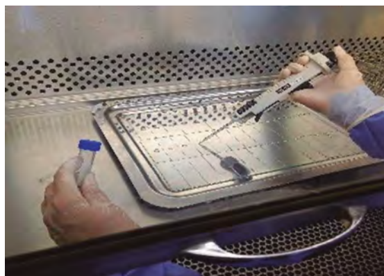
Procedimiento para la distribución de 30 \mu l de suspensiones bacilares sobre los portaobjetos utilizando una pipeta multidispensadora
