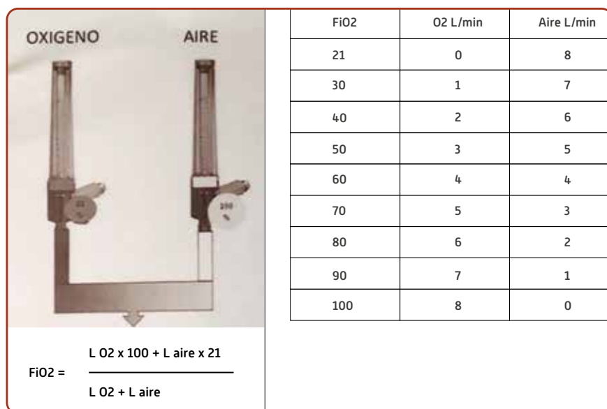
Figura 24: Mezclador de gases (aire/oxígeno) artes. L O 2 : litros de oxígeno, L aire: litros de aire.
