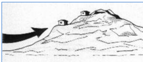
Figure 39 : La figure illustre les flux de vent ascendants qui viennent s'ajouter le long d'une pente, et qui créent des surpressions au sommet. (Source X)
