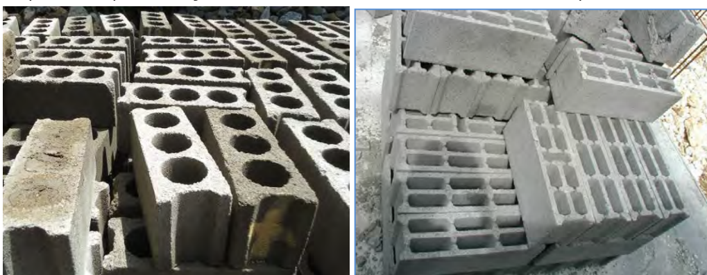
Figure 7 : A gauche, blocs vibrés à graviers fins produits au Cap Haïtien. L'utilisation de ce type de blocs pour les murs de contreventement peut être envisagée pour les bâtiments annexes à simple rez-de-chaussée.
