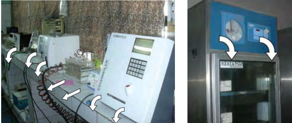
Figure 49 : Exemples de matériels sensibles pouvant tomber en l'absence de mesures appropriées. (Source Geohazard, India)
