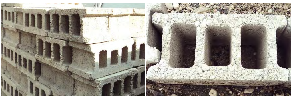
Figure 6 : Exemple de blocs non vibrés fabriqués artisanalement à Port-au-Prince, avec des graviers trop gros, à ne pas utiliser pour la maçonnerie de contreventement en raison de leur manque de résistance.
