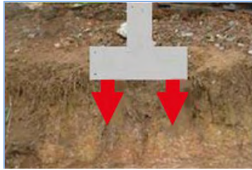
Figure 2 : Coupe sur sol montrant deux couches de natures différentes, et schéma théorique de position incorrecte d'une semelle, dont la charge (flèches rouges) s'applique sur un sol de résistance insuffisante. (Source ANCO)
