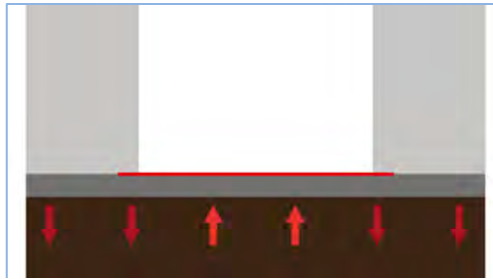
Figure 8 : Représentation schématique de l'inversion des efforts sur un tronçon de semelle filante non chargé entre deux murs. (Source ANCO)
