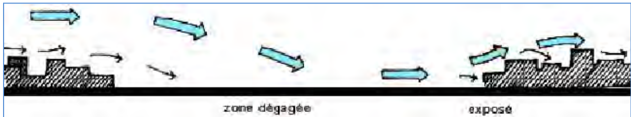
Figure 40 : L'effet de masse de l'urbanisation ralentit la vitesse des vents en ville entre les bâtiments, mais localement, des alignements sur rue peuvent accélérer la circulation du vent. (Source ENSAM)
