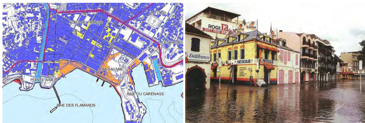
Figure 44 : Exemple de cartographie de l'aléa « submersion » (orange ou jaune selon la gravité) dans le centre-ville de Fort-de-France. Photo du front de mer inondé. De nos jours, sur des zones aussi exposées, la construction et les aménagements seraient limités. (Extrait du PPR de la ville de Fort-de-France et photo BRGM)
