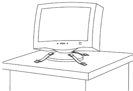
Figure 50 : Exemple de fixation de moniteur. (Source Geohazard, India)
