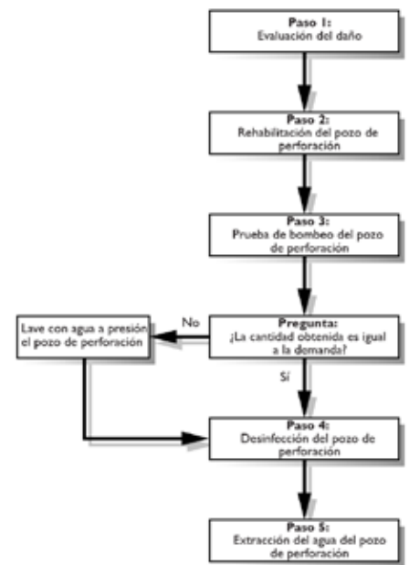
Figura 1 Pasos para la limpieza y desinfección de pozos perforados
