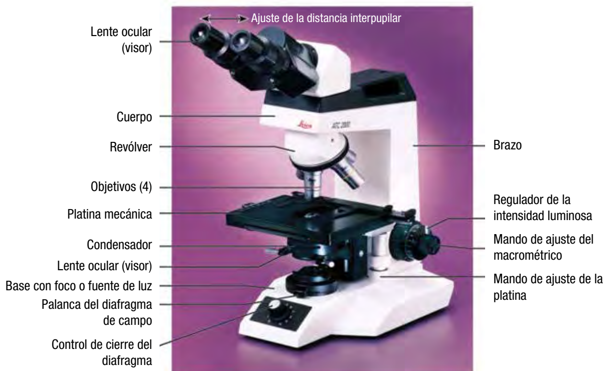
Figura A1.1 Componentes de un microscopio óptico
