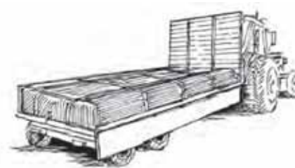
Figura 2 Camión cisterna improvisado
