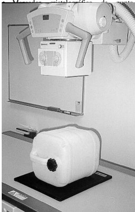
Fig. A-1. Contenedor plástico usado como maniquí para rayos- X.
