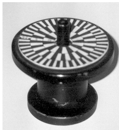
Fig. A-4. Verificador de exactitud del temporizador (Giroscopio). Dispositivo comercial.
