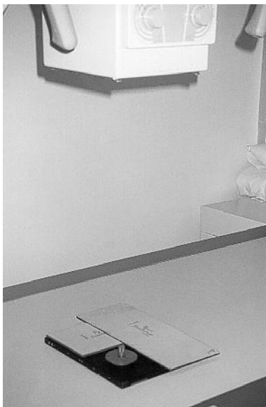
Fig. 3- 1. Prueba de exactitud del temporizador utilizando un giroscopio.
