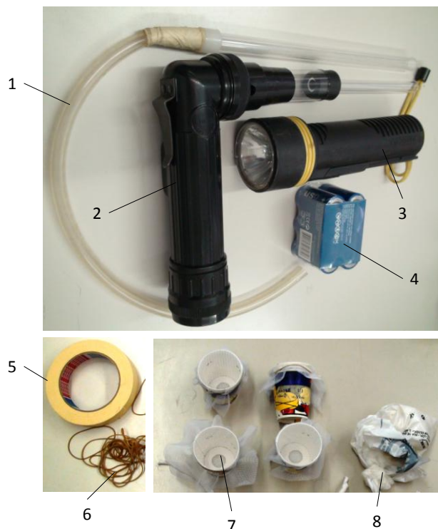
1. Aspirador bucal, 2. Aspirador mecânico, 3. Lanterna, 4. Baterias (pilhas), 5. Fita adesiva, 6. Elásticos, 7. Copos de papel tapados com rede, 8. Algodão.
