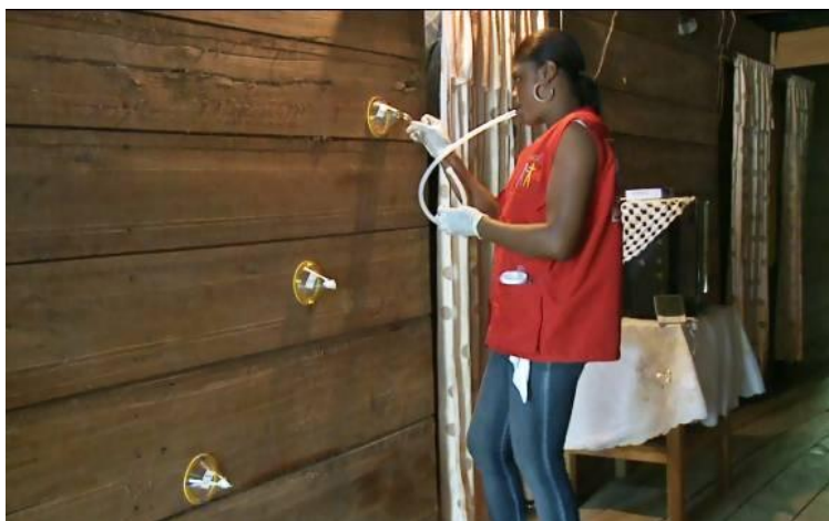
Figura 27. Bioensaio de cone da OMS aplicado numa parede
